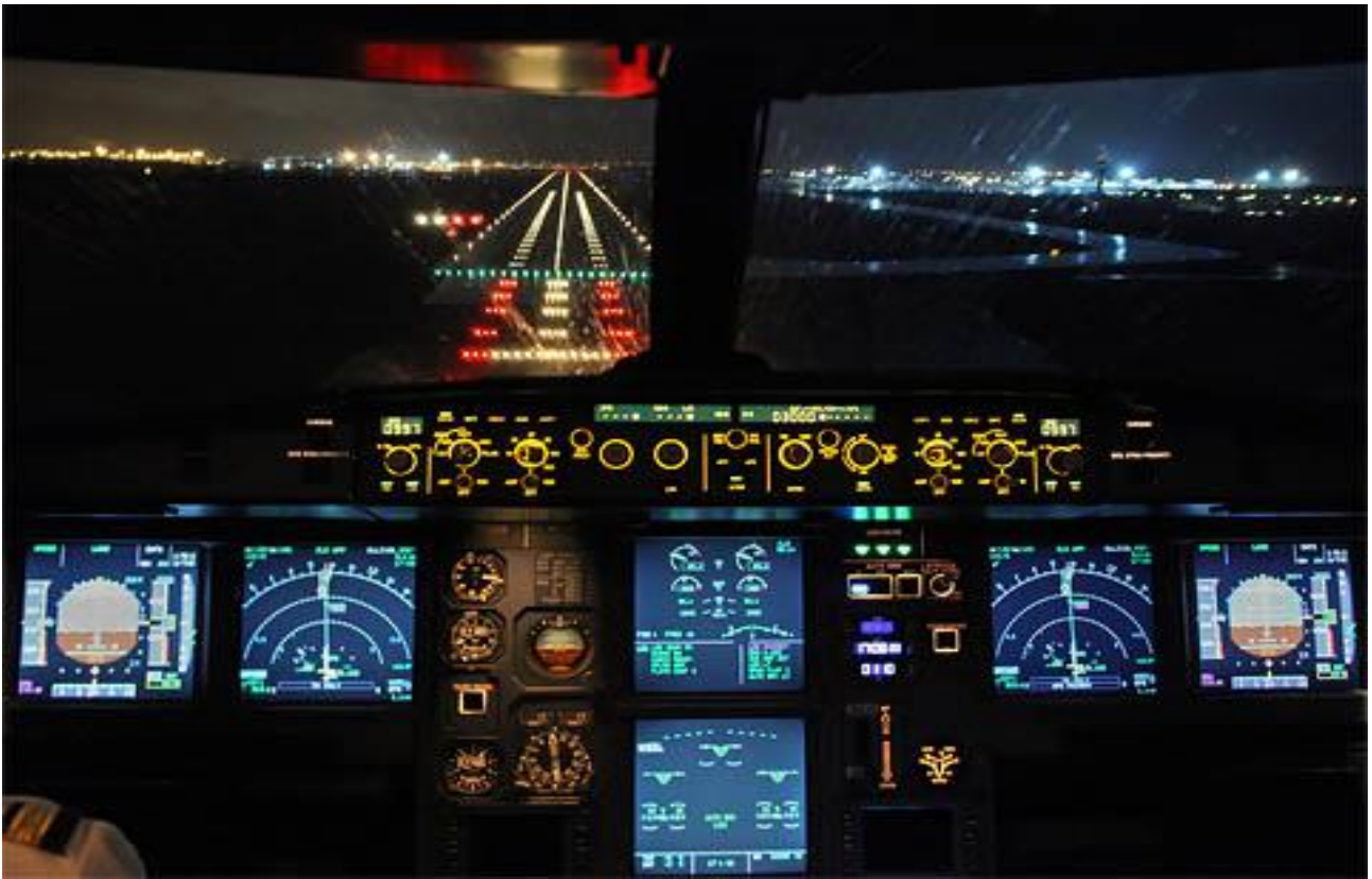
Εικόνα 1 - Τα φώτα επισήμανσης ορίων και άξονα του διαδρόμου, όπως φαίνονται από το πιλοτήριο αεροσκάφους
