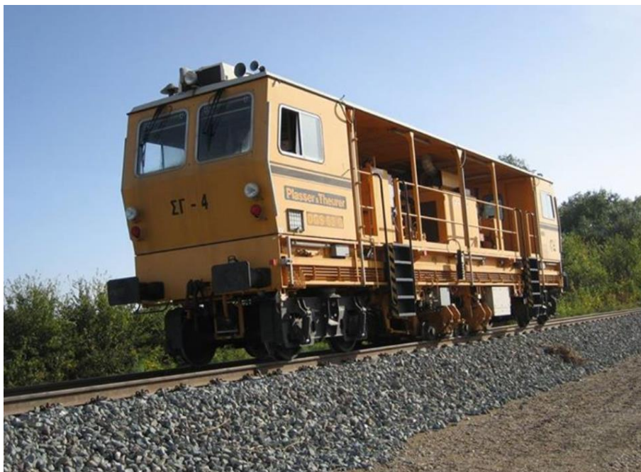
Εικόνα 3 - Δυναμικός σταθεροποιητής (σταμπιλιζάτορας) (dynamic track stabiliser)
