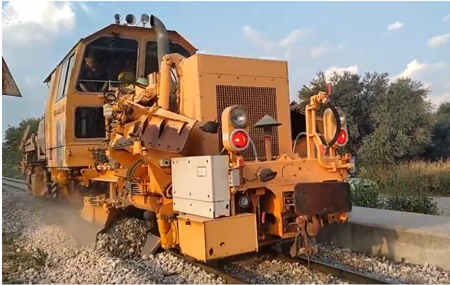
Εικόνα 2 - Ρεγκαλέζα (ballast regulator)
