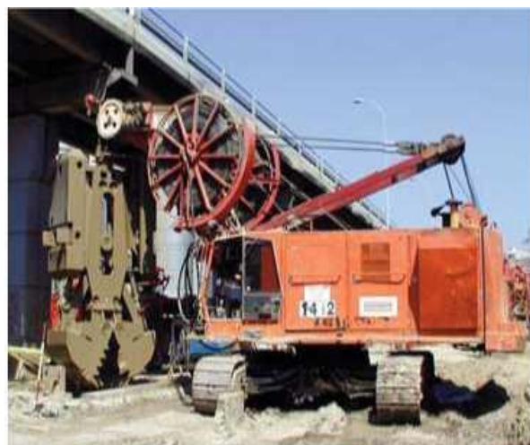
Εικόνα 3 - Αρπάγες μηχανικής λειτουργίας με συρματόσχοινο (μπένες)
