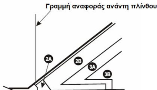
Σχήμα 2 - Λεπτομέρεια διάταξης ζωνών στον πόδα ανάντη λιθόρριπτου φράγματος με ανάντη πλάκα σκυροδέματος
