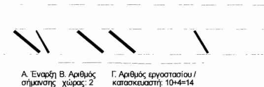
Σχήμα 2-4 Παράδειγμα σήμανσης για την αναγνώριση της χώρας και της μονάδας παραγωγής χάλυβα κατηγορίας B500C
