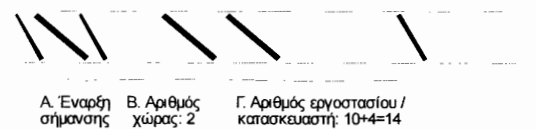
Σχήμα 2-6 Παράδειγμα σήμανσης για την αναγνώριση χάλυβα B500C που προέρχεται από κουλούρα
