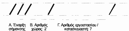
Σχήμα 2-5 Παράδειγμα σήμανσης για την αναγνώριση χάλυβα B500A που προέρχεται από κουλούρα
